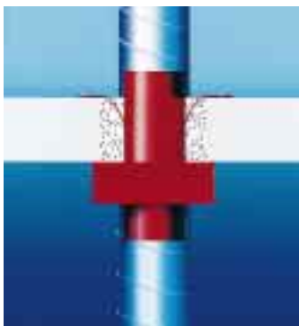
Das Brandschutz-Deckenschott wird in den Deckendurchbruch geschoben und auf dem Boden fixiert. Nach dem Ausgießen der Aussparung erfolgt das Setzen der Hauptleitung (Helios)
