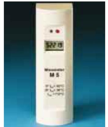
Elektronischer Heizkosten-verteiler Minometer M5 von Minol
