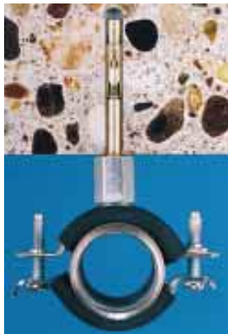
Lediglich 6 mm große Löcher müssen für den Nagelanker FNA von Fischer gebohrt werden
