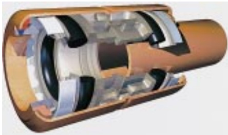
Eine Reduzierung der Arbeitszeit bringt das Zusammenstecken der Rohre und Fittings, wobei durch den Zahnring aus Stahl eine unlösbare Verbindung entsteht (Bild: IBP Deutschland)
