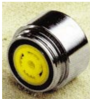
Durchflußmengenregler, diebstahlsicher dank endlos drehender Außenhülse und Wasserspar-Strahlbrause mit max. 3 l Durchfluß je Minute
