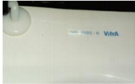
WC-Becken mit auf -6 endender Prüfnummer benötigen nur 6 l Wasser zum Spülen
