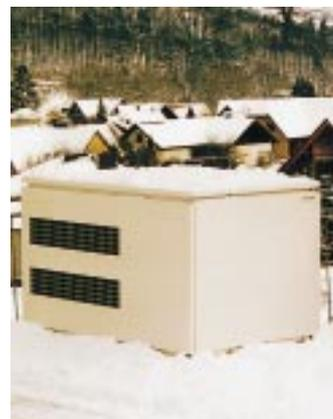
Ausgestattet wurde die Wärmepumpe mit zwei Verdichtern, von denen der eine in der Übergangszeit arbeitet, während beide zusammen den Wärmebedarf des Hauses im Winter abdecken. Dabei erreicht sie auch noch bei -18 °C eine Vorlauftemperatur von 65 °C.
