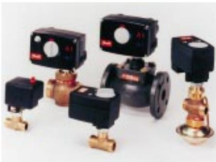
geeignet. Die Stellantriebe können mit einem Dreipunkt-Stellsignal oder mit einem stetigen Stellsignal 0–10 V angesteuert werden und sind mit und ohne Sicherheitsfunktion lieferbar. Eine kraftabhängige Endabschaltung verhindert eine Überlastung des Motors.
