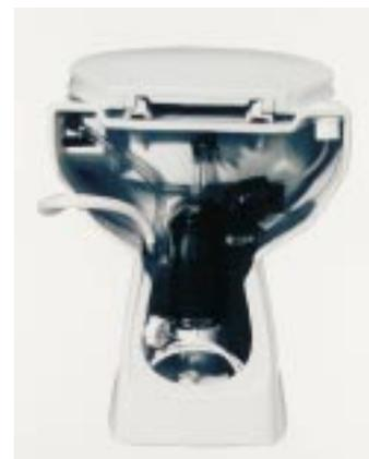
Aber auch Kleingartenanlagen oder Wohnmobile können mit diesem flexiblen Fäkalienzerkleinerer die Abwässer eines WC's und eines Handwaschbeckens ohne zusätzliche Desinfektion entsorgen. Das Gerät hat eine Förderleistung bis zu 3 m in der Höhe oder 30 m in der Waagerechten. Es ist für Entsorgungsleitungen von 32 mm Durchmesser konzipiert und benötigt je Spülung lediglich 4 l Spülwasser.
