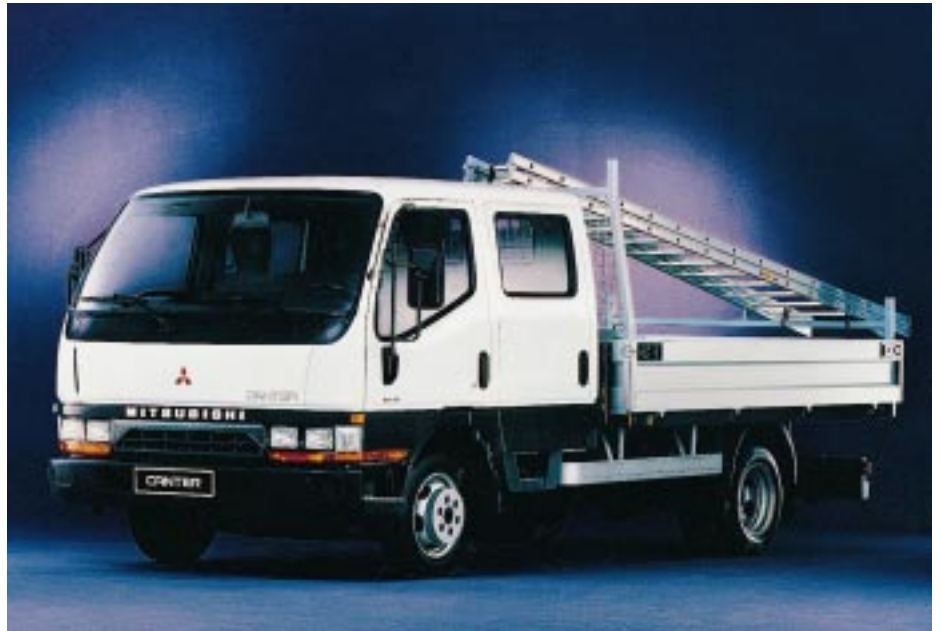
Mitsubishi startet seine Canter-Baureihe mit dem T 35, der sich als Pritsche mit Einzel- oder Doppelkabine oder mit Koffer ordern läßt. Eine Auflastung des Fahrgestells auf 4 Tonnen ist möglich
