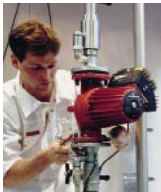
Zum G-Plus Praxistraining gehört auch der Pumpenaustausch und die Pumpeneinstellung am Modell
