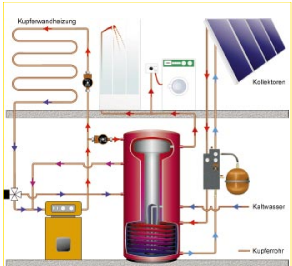
Bild 6 Solare Zuheizung über Rücklaufanhebung
