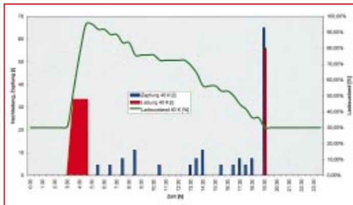
Ladecharakteristik „EcoCondens“ in Anlehnung an DIN 4702, T8, ZP 120
