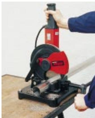
spannt. Die mit lediglich 17 kg baustellengerechte Maschine ist mit einem feingezahnten Metallkreissägeblatt von 225 mm Durchmesser ausgestattet, dessen Zähne einen auf die zu trennenden Materialien bezogenen Spezialschliff erhielten.
