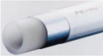
stumpfgeschweißt. Das Verbundrohr ist auf eine maximale Betriebstemperatur von 95 °C und einen Höchstdruck von 10 bar ausgelegt. Die Formstücke des DVGW-geprüften Systems sind aus dem korrosionsresistenten Werkstoff Rotguß Rg 5 gefertigt.
