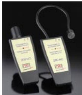
genannten Gasschnüffler gibt es für brennbare Gase (HC) und Kohlenmonoxid (CO). Das HC-Gerät ist mit einem biegsamen Sensorhals ausgestattet, der das Orten von Leckagen in schwer zugänglichen Bereichen gestattet. Gaskonzentrationen ab 200 ppm werden über eine rote LED, kombiniert mit einem akkusti-
