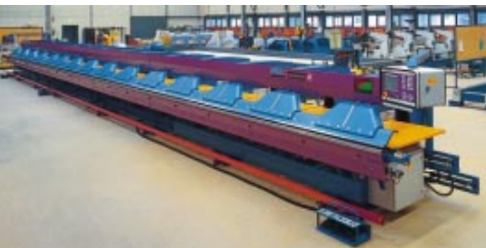
... Zusammengekoppelt haben sie eine Abkantlänge von 18,2 m. Die Mastersteuerung rechts steuert dabei die Gesamtanlage
