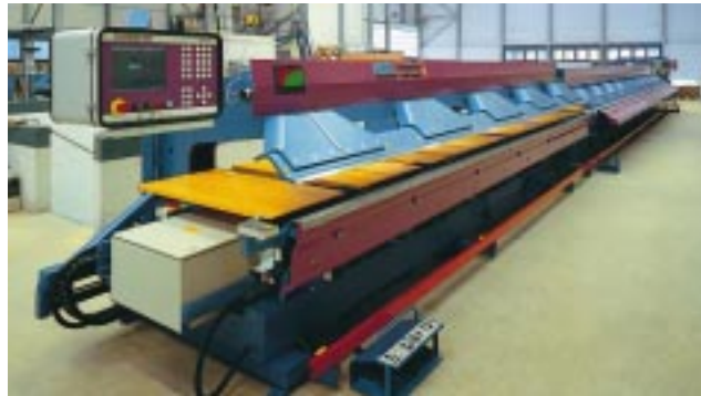
Zwei Maschinen mit einer Arbeitslänge von 12,0 m und 6,2 m auf einer gemeinsamen Unterkonstruktion. Jede Maschine ist unabhängig voneinander steuerbar ...
