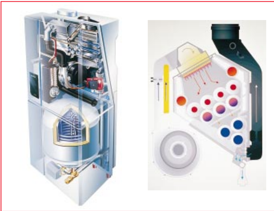
Bild 7a, 7b Funktionsprinzip eines Gebläse-Vormischbrenners mit glühender Brennerfläche (GB112)
