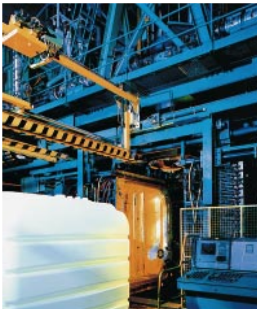
Auf selbstentwickelten Anlagen produziert das Unternehmen im Blasformverfahren nach eigenen Angaben das größte Container-, Heizöl- und Industrietankprogramm Europas
