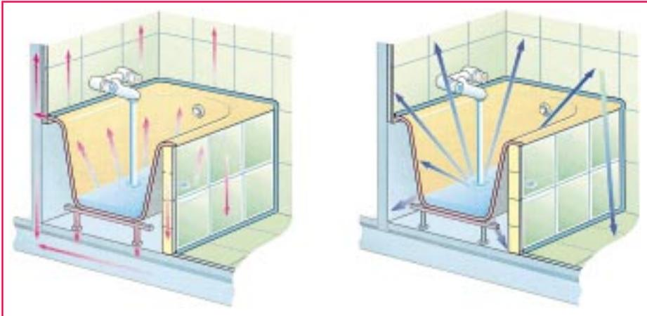
Während sich der durch das einfließende Wasser entstehende Körperschall bei direkter Wannenaufstellung und -befestigung über die Wanne auf den Baukörper und damit auf die Nachbarnwohnung überträgt (I.), strahlt der Luftschall in den Raum ab und wird im Baukörper in Körperschall umgewandelt
