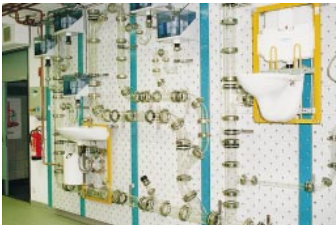
Ablaufdemonstrationswand im neuen Labor der Frankfurter Philipp-Holzmann-Schule
