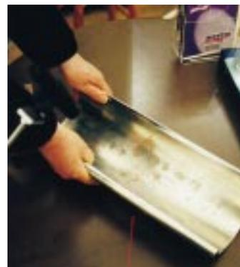
*Das Anzeichnen von Gehrungslinien – z.B. für das Zuschneiden von Rinnenwinkeln – wird durch den Linien-Laser von Richter erleichtert*
