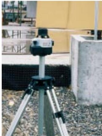
**In bis zu 50 m Entfernung lassen sich mit dem halbautomatischen Rotationslaser von Bosch in Punkt- oder Linienmodus Höhenverläufe und Referenzlinien ermitteln**
