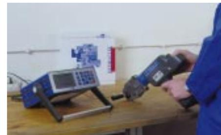
**Mit dem transportablen Meßsystem Active 9000 SAN können alle handelsüblichen Preßwerkzeuge – auch auf der Baustelle – überprüft werden**
