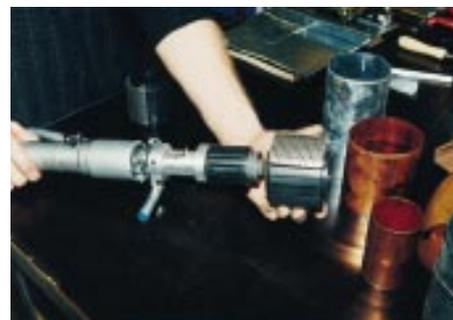
*Das hydraulische Rohr-Aufweitgerät besitzt drei Aufweitesegmente, die – je nach Größe des Fallrohres – übereinandergesteckt werden können*
