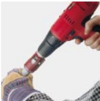
Mit dem **Rograt MSR** werden die Enden von **Mehrschicht-Verbundrohren** optimal auf die **Weiterverarbeitung** mit **Preßfittings** vorbereitet
