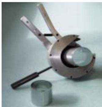
*Durch Ratschenbewegung lassen sich Fallrohre mit dem Rohrab-schneider von Masc im Ständer, aber auch vor Ort ablängen*
