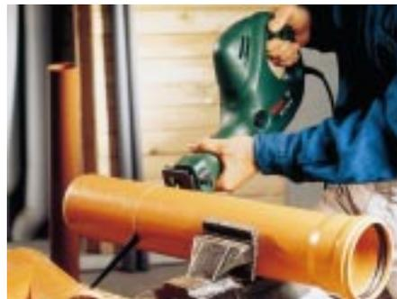
**Die Hubzahl der Fuchschwanzsäge mit dem 710 W-Motor läßt sich elektronisch und stufenlos von 500 bis 2600 Hüben pro Minute regeln**
