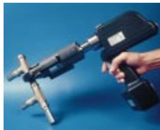
**Das Akku-Preßhandy von Holger Clasen überwacht elektronisch alle Verpressungen von Rohrleitungen**
