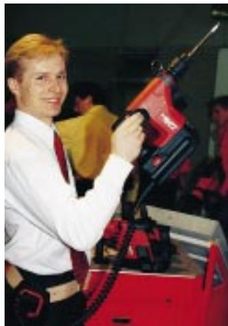
**Der Akku des Bohrhammers TE 6-A läßt sich im Gürtel unterbringen und reduziert damit das Maschinengewicht**
