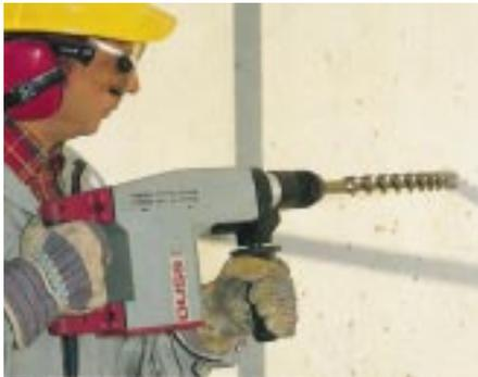
**Mit Vollbohrern schafft der Kombihammer PX 46 von Duss bis zu 55 mm Bohrdurchmesser, mit Hohlbohrkronen 90 mm**
