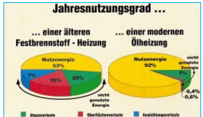
Bei modernen Ölheizungsanlagen liegt der Anteil nicht genutzter Energie um 40 % niedriger als bei Festbrennstoff-Heizungen älterer Bauart
