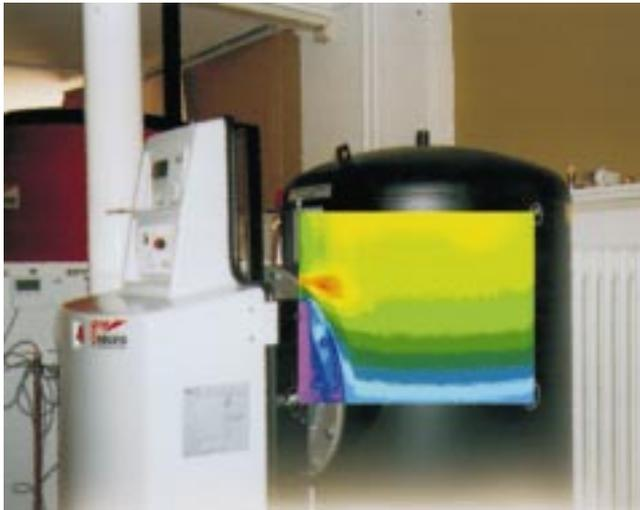
**Bild 13** Messaufbau, Erfassung der Brennkammer und des darüberliegenden Warmwasser-Pufferbereichs
