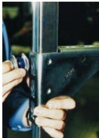
*Das zu Monzi-Fix von Wopf gehörige Unischloß wird durch den Konsolwinkel in die mit gezahnten Innenkanten versehene Montageschiene gesteckt und mit einer 90°-Drehung arretiert*
