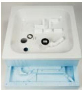
*Installationsfreundlich ist Poresta-3Plus von Correcta gestaltet: Die Wanne ist fest mit dem Wannenträger verschäumt, die Ab- (und Über)laufgarnitur ist fest bereits vormontiert und die Rohrverlegung erfolgt gut zugänglich in der separaten Montageplatte*
