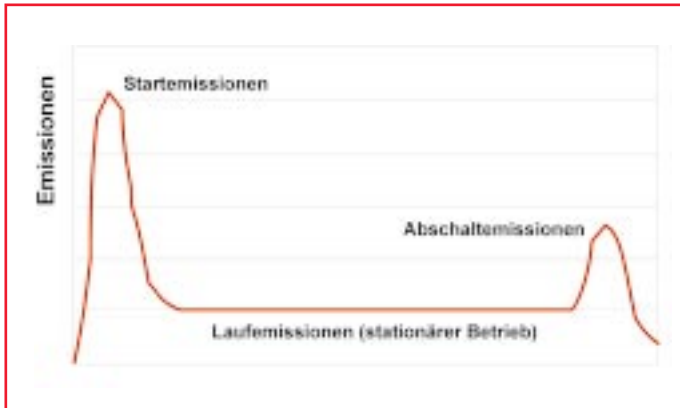
Bild 3 Emissionsentwicklung beim Betrieb von Heizkesseln
