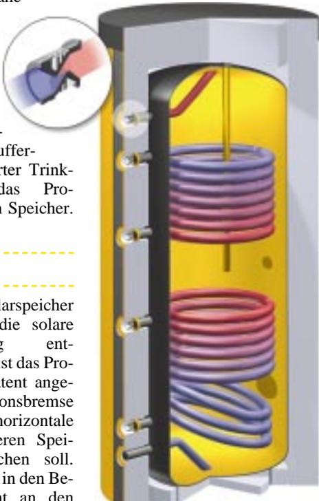
**Der ECOplus-Solarspeicher von Wagner ist mit der zum Patent angemeldeten Konvektionsbremse Convectrol ausgestattet**
