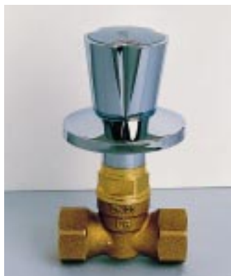
Das Unterputzventil von Rossweiner besteht aus einem den vollen Durchfluß bietendem Rotgußunterteil, einem Messingoberteil mit EPDM-Dichtkolben sowie verchromtem Griffaufsatz
