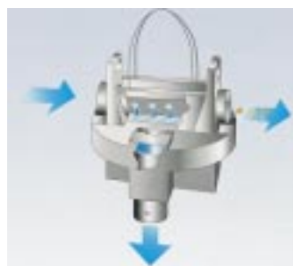
Das Filtersystem Lupo hat seinen Namen vom Luftpolster, das sich bei voller Zisterne bildet und eine Reinigung des ersten Filtersiebes bewirkt
