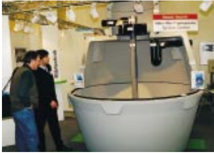
Der aus Beton gegossene Öko-Regenwasserspeicher, Typ Euro-Comfort, hat ein Gesamtgewicht von 4,6 t bei 5,3 m 3 Volumen und ist mit einem Spaltsieb-Rohrfilter und Schmutzauffangwanne sowie beruhigtem Zulauf und Überlaufsiphon ausgestattet
