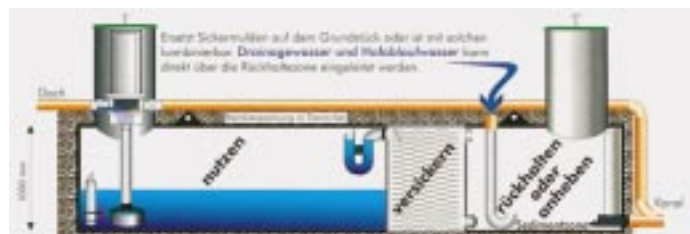
Das Dachablaufwasser läßt sich mit dem Regenwasser-Bewirtschaftungs-System RBS von Elwa Wassertechnik nutzen, versickern und rückhalten, und das in verschiedenen Variationen. Im linken Domschacht ist ein Rohrfilter zur Absonderung von Laub und grobem Schmutz angeordnet
