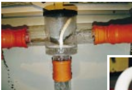
Das Regenwasser fließt ohne Höhenversatz durch den Filterschacht von Schwarzkopf Wassertechnik, wobei es über ein Fadensieb aus Edelstahl geleitet wird, das Wasser und Schmutz zu einem hohen Prozentsatz trennt
