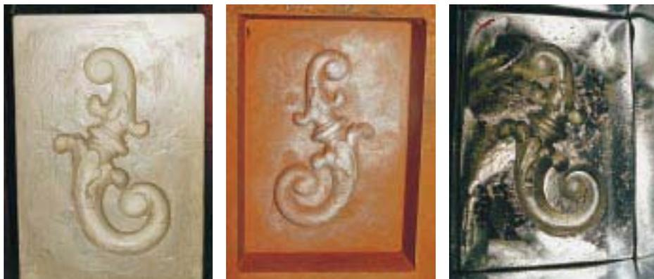
Zur Herstellung eines Schnörkels wird von einem gut erhaltenen Original ein Gipsabdruck hergestellt, der zur Anfertigung der Gießform dient, von der dann eine Matrize aus Zink gegossen wird (v. l.). In die Form treibt der Klempner die Schnörkelhälften aus Titanzinkblech
