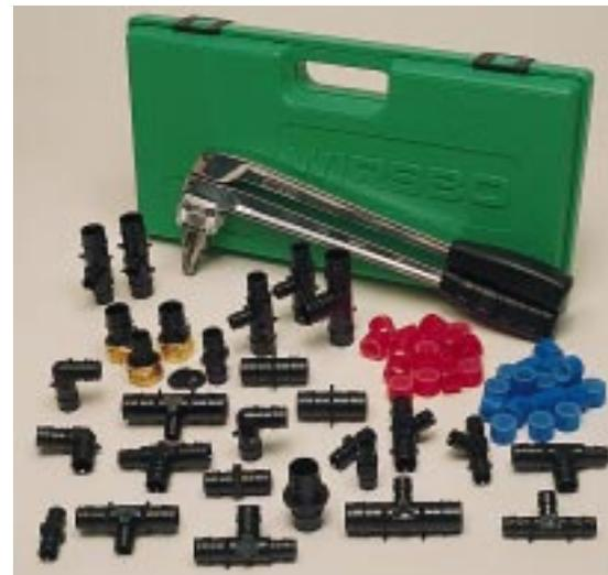
Wirsbos verbesserte PE-X-Rohr-Verbindung: Das Rohrende mit dem Q & E-Ring schrumpft jetzt auf den Stutzen eines Fittings aus Polysulfon auf, statt aus Messing
