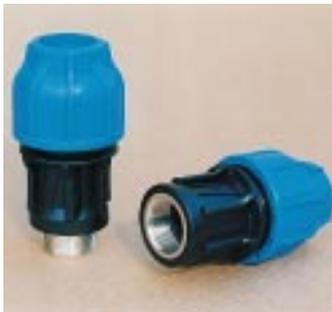
*Übergangsstücke von Polyethylen auf metallische Rohre sind von Glynwed in den Abmessungen von 20 bis 63 mm Außendurchmesser und entweder mit Innen- oder Außengewinde von 1/2" bis 2" erhältlich*
