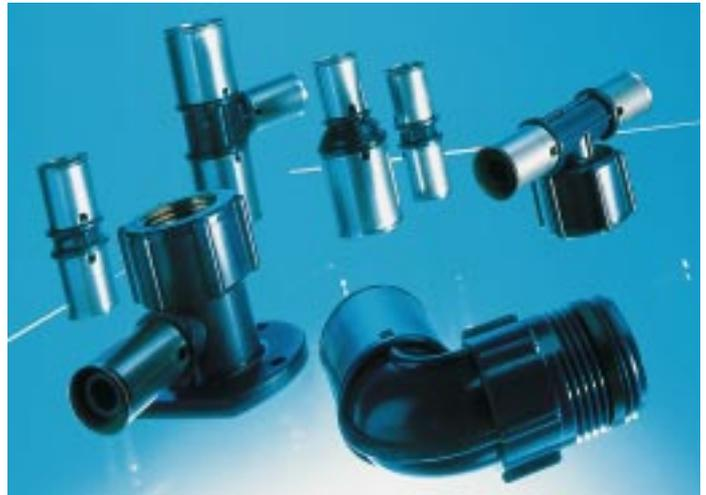
Durch Preßfitting aus Polyphenylsulfon und Verbundrohren aus PEX und Aluminium bietet Wavin ein Rohrsystem an, in dem das durchfließende Medium nicht mit Metall in Berührung kommt
