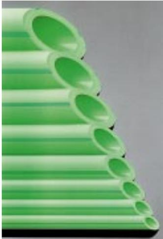
*Stabi-Faserverbundrohre aus Polypropylen in den Durchmessern 20 bis 110 mm von Aquatherm sind leicht und schlagzäh und können direkt mit den Fusiotherm-Fittings verschweißt werden*
