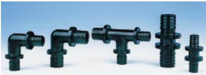
Der PPSU-Fitting für Heizung und Sanitär kommt ohne O-Ring aus; die Verbindung erfolgt durch Verpressung zusammen mit einer Druckhülse, die bei PE-X-Rohren aus Messing vernickelt und bei Verbundrohren aus blankem Messing gefertigt ist
