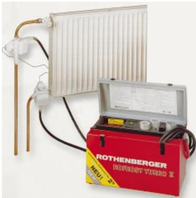
*Das FCKW-freie Einfrieren von Rohren des Heizungs- oder Sanitärbereiches ist nun bis zu einem Durchmesser von 60 mm möglich*
