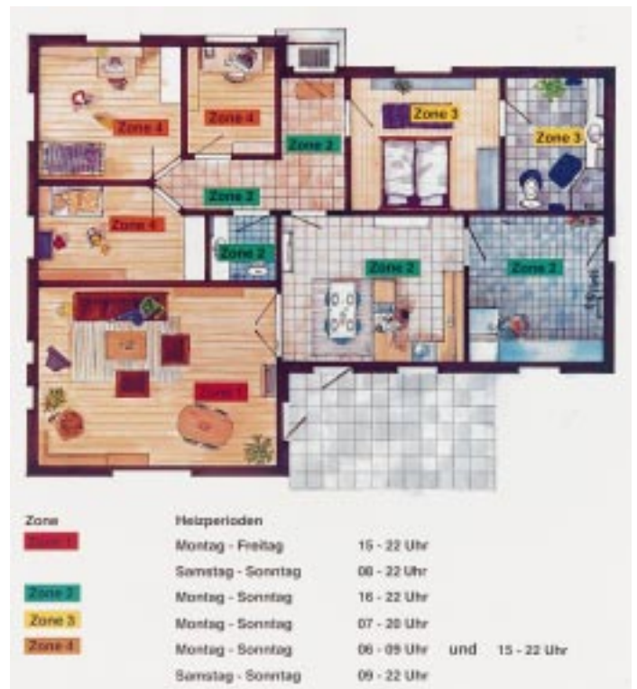
Mit dem CF-System lassen sich Heizzonen mit unterschiedlichen Heizphasen und einteilen (Danfoss)
