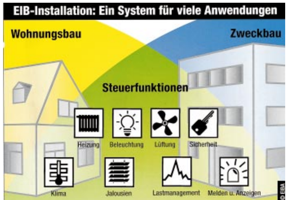
Mit dem Europäischen Installationsbus lassen sich Aufgaben der TGA gewerkübergreifend in einem System integrieren
