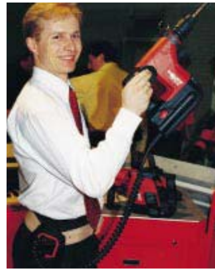
Bei dieser Hilti wird der Akku in den Gürtel gesteckt. Ergebnis: Der Bohrhammer wurde 2 kg leichter
