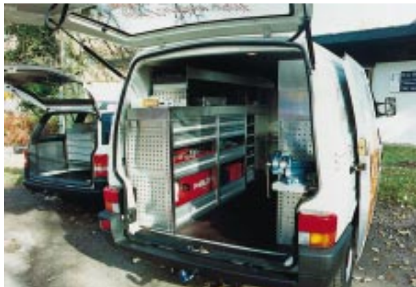
Die neuen Werkstatteinbauten ohne überstehende Kanten, Griffe und Knöpfe
