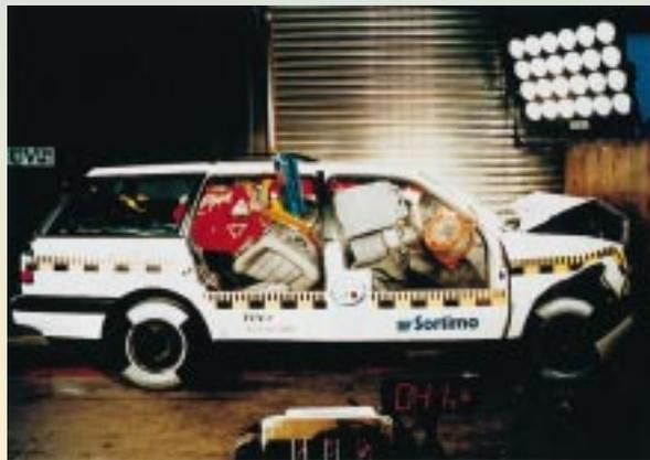
*Bei einer Aufprallgeschwindigkeit von 48,7 km/h reißt die ungesicherte Ladung schon nach 126 Millisekunden die Rücksitzbank aus der Verankerung und schießt in den vorderen Bereich der Fahrgastzelle*
