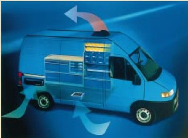
**So lassen sich bei 50 km/h mit einem achtfachen Luftwechsel Explosionen beim Gasflaschentransport vermeiden. Dreht man den Dachlüfter um, wirkt das System als Belüftungsanlage**
