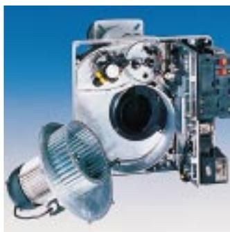
Brennkopf, Gehäuse und Mischeinrichtung der Brenner werden separat montiert. Schalt- und Bedienfeld sind im Brennergehäuse integriert. Getrennt von der Luftströmung sind Feuerungsautomat, Luftklappenantrieb, Zündtransformator sowie weitere elektrische Komponenten staubgeschützt untergebracht.
