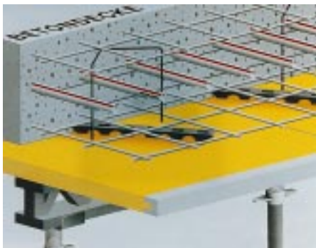
Wasserdurchströmte PE-Xa-Rohre in den Geschoßdecken decken die Grundlasten der Heizung und Kühlung
