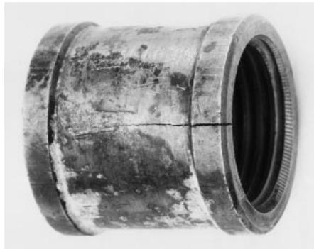
**Bild 1** Messingmuffe mit Längsriß aus einer Trinkwasseranlage
