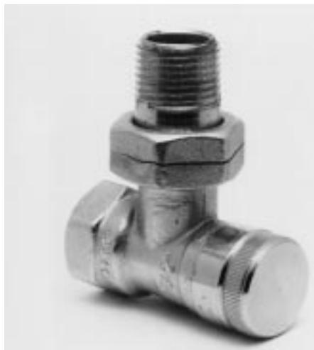
**Bild 2** Absperrbare Heizkörperverschraubung mit radialem Bruch der Überwurfmutter
