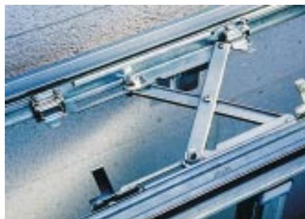
Der Abstandhalter läßt sich stufenlos bis zu 250 mm verstellen – nach Lösen der Mittelschraube auch schräg
