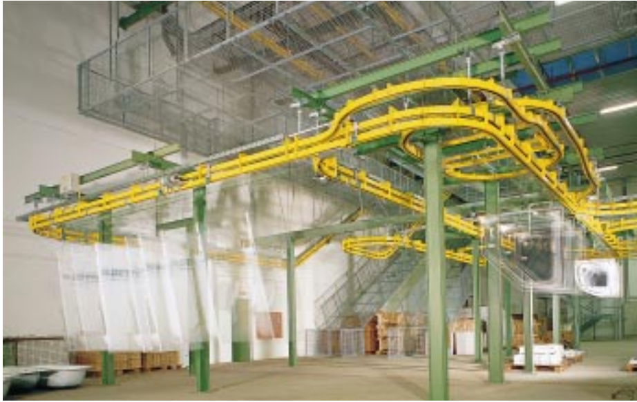
Ein modernes Transportsystem befördert die Produkte zu den Kommissionierungsplätzen
