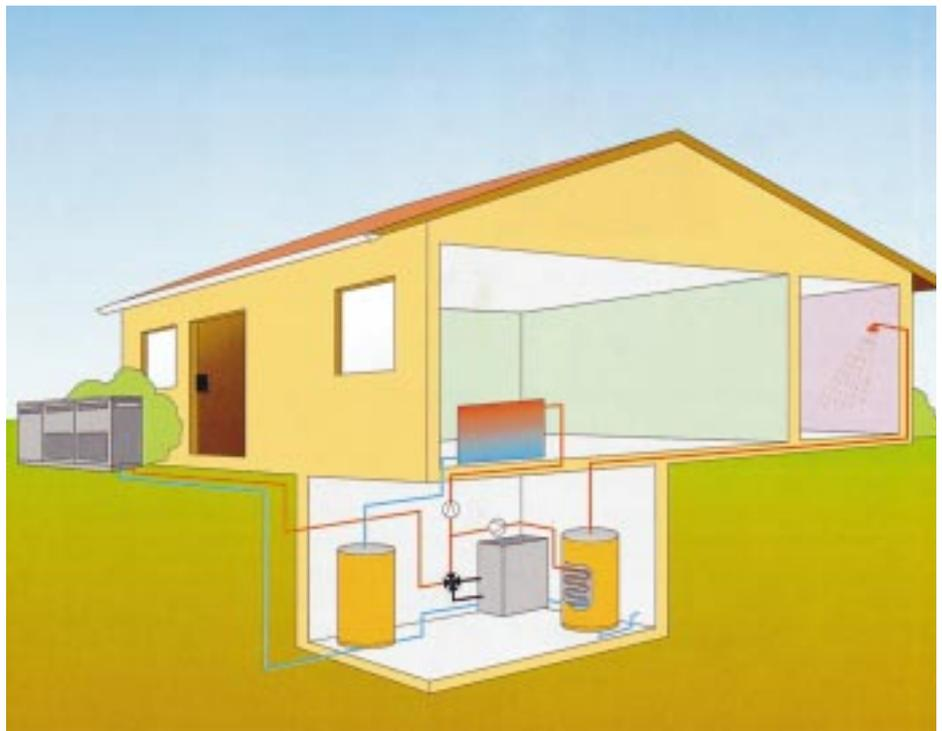
*Luft als Wärmequelle hat den Nachteil, daß bei niedrigen Außentemperaturen nur eine niedrige Heizleistung zur Verfügung steht [2]*
