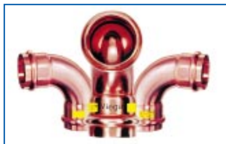
Die Gas-Fittings, die es für die Nennweiten DN 12 bis DN 50 gibt, sind beidseitig mit einem gelben Streifen gekennzeichnet
