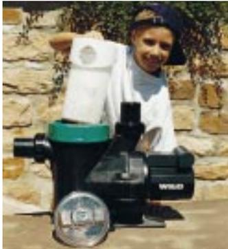
griffen ist der Filterkorb gereinigt. Die Pumpe ist ein „Naßläufer“: Der Motor wird vom Wasser gekühlt und geschmiert. Das vermeidet, daß Laufgeräusche nach außen dringen. Da keine Gleitringdichtung vorhanden ist, ist die Pumpe wartungsarm und arbeitet praktisch verschleißfrei.
