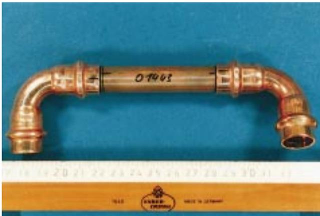
**Bild 10** Vergleichsprüfungen mit der Preßmaschine, die am Schadenort eingesetzt wurde. Links eine Verbindung mit ebenfalls um 1,5 mm vor dem Preßvorgang herausgezogenem Rohr, rechts vollständig in den Fitting gesteckt. Beide Verbindungen sind bei der Druckprüfung wasserdicht, die linke Verbindung läßt sich aber ohne größere Kraftanstrengung aus dem Fitting ziehen
