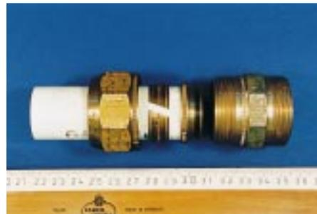
**Bild 7** Klemmverschraubung aus Messing mit Verbundrohr, Schaden durch herausgerutschtes Rohr. Ursache: Verschraubung nur handfest angezogen, daher mangelnde Klemmwirkung auf Verbundrohr
