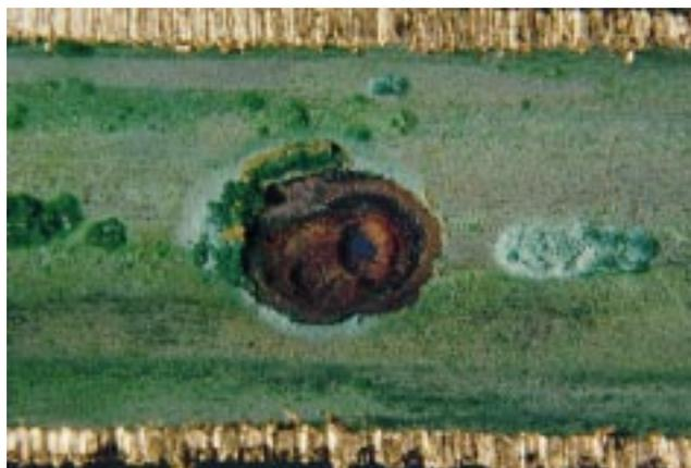
Bild 1 Innenansicht Kupferrohr, Rohrbruch durch kaltwasser-spezifische Lochkorrosion
