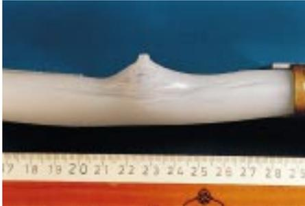
**Bild 6** PE-X-Rohr, durch Übertemperatur und Wasserdruck geplatzt. Ursache: Anschluß unmittelbar an Kaltwassereingang eines gasbetriebenen Durchlauferhitzers ohne Rückströmsicherung
