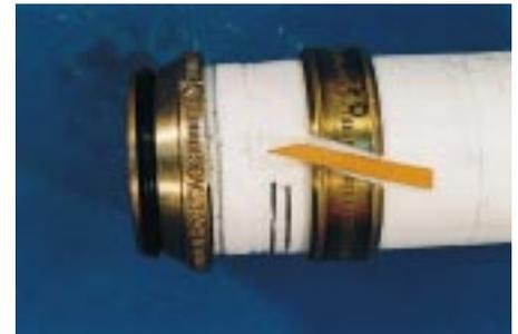
**Bild 8** Gelöste Klemmverschraubung nach Installationsvergleich und Druckprüfung. Deutlich erkennbare Oberflächenverformungen des Verbundrohrs, Stützhülse und Rohr sind untrennbar miteinander verbunden
