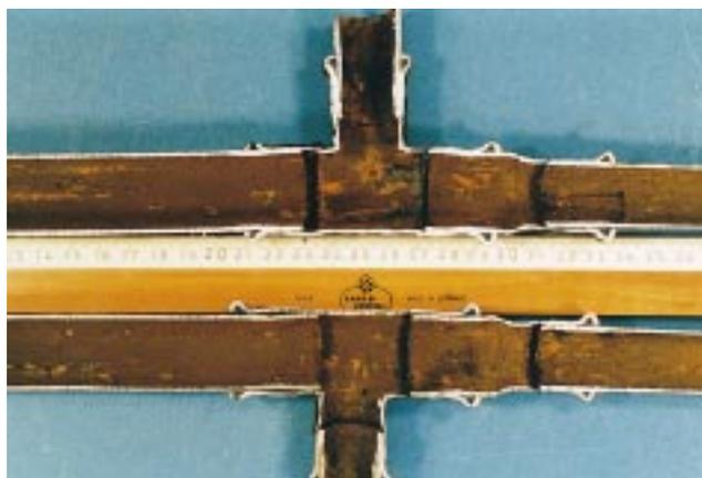
**Bild 5** . . . Die Innensicht zeigt, daß alle Verbindungen zum Zeitpunkt des Schadens dicht waren
