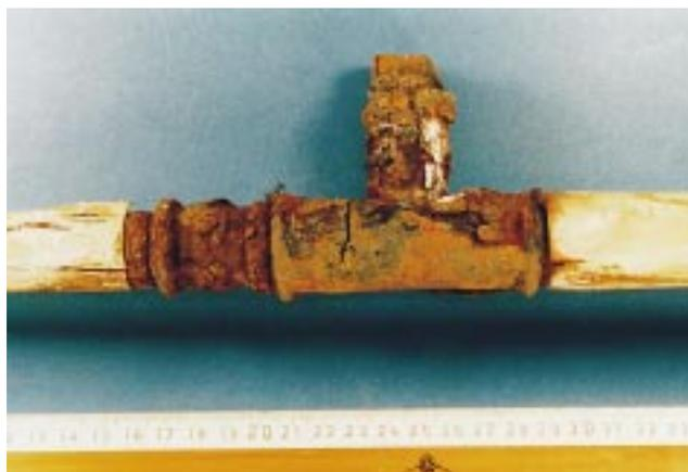
**Bild 4** Trinkwasserleitung mit Preßfittingverbindungen, ungeschützte Bereiche durch Außenkorrosion zerstört. Ursache: Rohr aus schwarzem Stahl statt nichtrostendem Stahl und nicht beseitigte Feuchtigkeit eines früheren Schadenereignisses . . .
