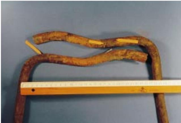
**Bild 3** Heizungsrohre aus schwarzem Stahl, angegriffen durch Außenkorrosion. Ursache: nicht beseitigtes Löschwasser im Heizungsschacht von einem Brandereignis während der Installationsphase
