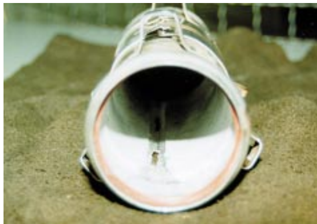
Bild 2 Riefenförmiger Abtrag des Aluminiums
