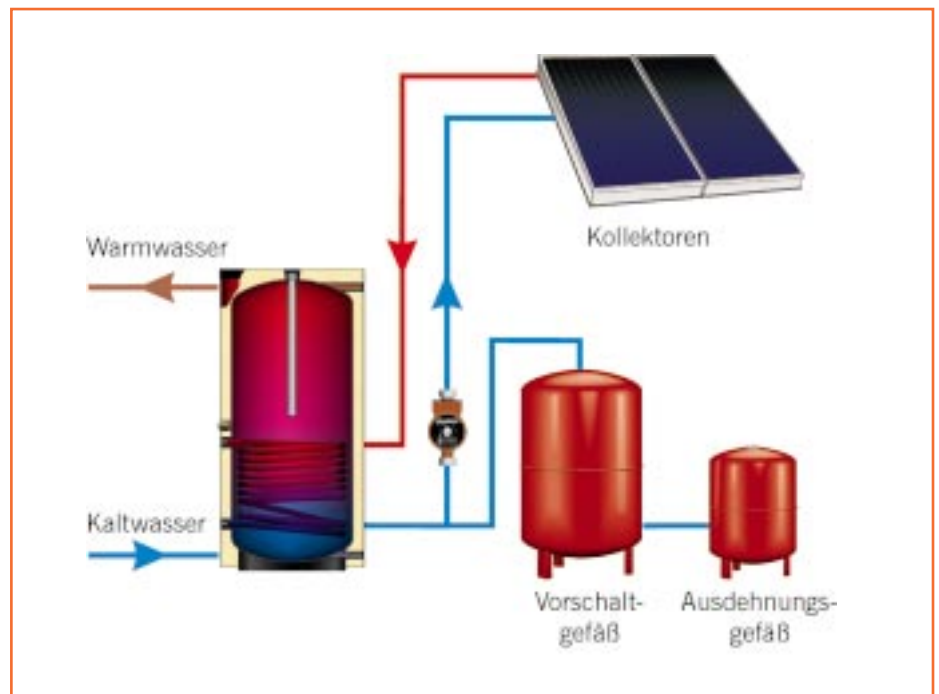
Einbau von Ausdehnungsgefäßen (vor der Pumpe mit Rohren); im Vorlauf mit Vorschaltgerät
