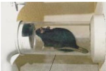
festigt wird. Gleichzeitig dient die Klappe auch als Geruchsschutz bei stark riechenden Abwasserleitungen und bedingt als Rückstauklappe. Sie besteht aus glasfaserverstärktem ABS-Kunststoff und ist im Kernbereich mit 0,5 mm dickem Edelstahlblech verstärkt. Asu letzterem Material sind auch Schenkelfeder, Splintsicherungsbolzen und Befestigungsring hergestellt. Im Langzeittest funktionierte der Klappmechanismus auch nach 30 000 Zyklen noch.
