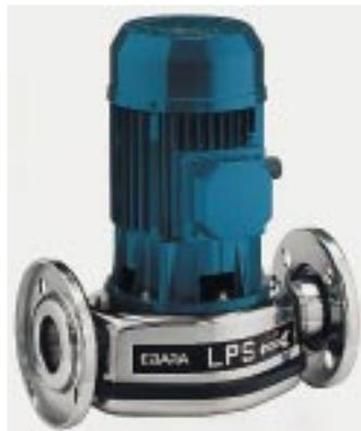
die kompakte Pumpe für die Zirkulation von Medien in Heizkreisläufen (bis 100 °C) oder Kühlkreisläufen (bis -10 °C) an. Die Pumpen sind mit oberflächengekühlten Motoren ausgestattet. Im Gegensatz zu Spaltrohrmotoren sind solche Trockenläufer bauartbedingt wirtschaftlicher im Energieverbrauch. Im Kühleinsatz gibt der Trockenläufer-Motor keine Motorwärme an das Kühlmedium ab.
