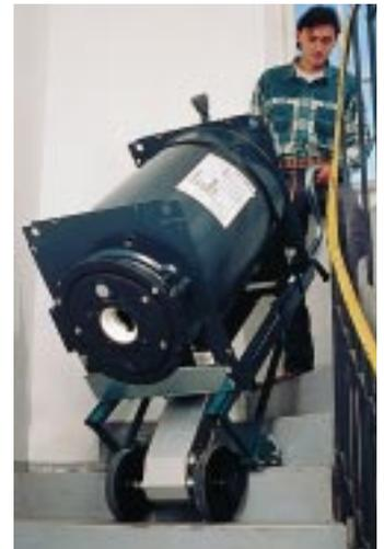
fen/Minute möglich. Es besitzt eine größere Bodenfreiheit sowie eine geschäumte, pannensichere Profilbereifung. Durch Schnellwechselakkus ist ein praktisch unterbrechungsfreier Dauerbetrieb möglich. Ein weiteres Modell ist der CargoMaster A 310 (unser Bild). Er hat eine Hebeleistung von 310 kg, besitzt eine kontinuierlich regelbare Steiggeschwindigkeit von 4–10 Stufen/Minute und größere Bodenfreiheit.
