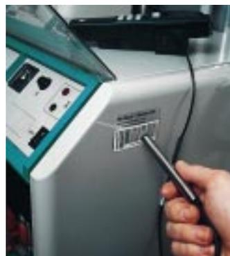
Barcode-Stift. Mit der Windows®-Software wird der Barcode auf die Karteikarte oder auf ein Klebe-Etikett ausgedruckt. Die Bezeichnungen können bis zu 20 Ziffern oder Buchstaben enthalten. Die im Barcode enthaltenen Informationen werden mit dem Barcode-Stift in das Analysegerät eingelesen.
