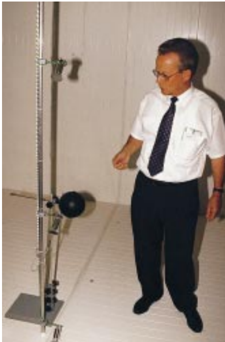
Laborleiter Uli Fischer erläuterte die Messung der Lufttemperatur, die an dem Ständer in drei Höhen erfolgt
