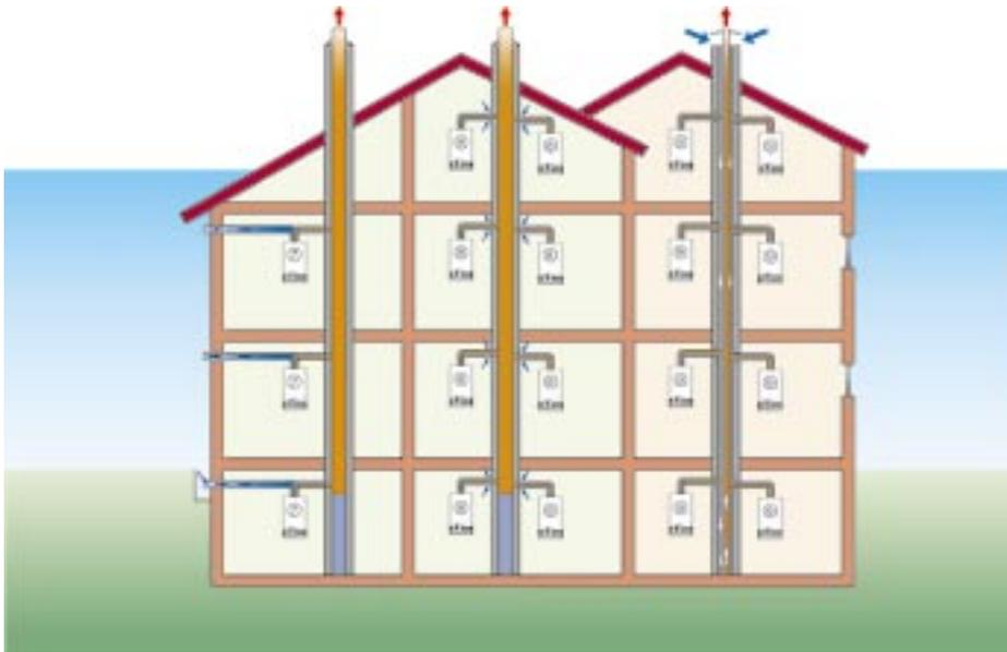
Mehrfachbelegung raumluftunabhängiger Kesselthermen an einem LAS
