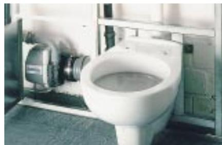
bine und Rückstauklappe ausgestattet und pumpt Abwässer durch ein DN 32-Rohr bis zu 4 m hoch oder 60 m weit. Ausgerüstet ist sie mit einem 450 W-Motor, der mit 3000 U/min läuft. Der Förderrohranschluß ist flexibel und drehbar
