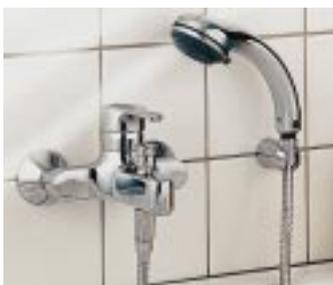
Für die gezielte Absicherung potentieller Gefahrenquellen sind ein Brauseschlauch-Anschlußbogen sowie ein „Doppel-Rückflußverhinderer“ zur nachträglichen Montage an Wannenfüll- und Brausebatterien (s. Bild) erhältlich. Mit den beiden DVGW-registrierten Sicherungskombinationen werden 1/2-Zoll-Brauseschläuche zuverlässig abgesichert.
