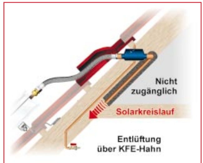
Entlüftung durch einen Zentralentlüfter bei ausgebautem Dachschob
