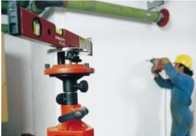
*Die Laserwasserwaage PL 10 besitzt ein eingebautes Lasermodul und Peilsystem und ist besonders zum Ausrichten gedacht*
