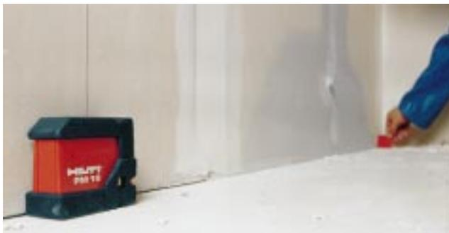
*Selbstnivellierend arbeitet der Dreiaachsenlaser PM 10. Es sendet aus einem Zentrum gleichzeitig drei Laserstrahlen aus*
